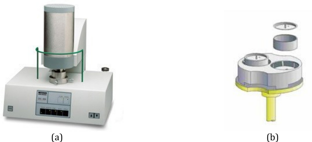
Obrázek 3.1 DSC kalorimetr 404C Pegasus (Netzsch) celkový pohled (a) a detail držáku kelímků (b)
